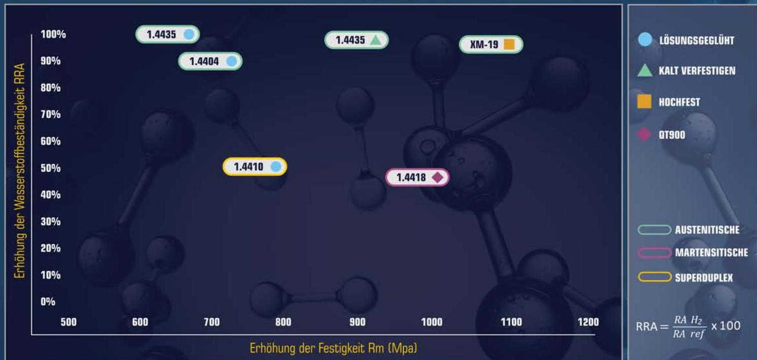
Werte basieren auf Tests mit Hohlkörper Proben bei 150 bar
